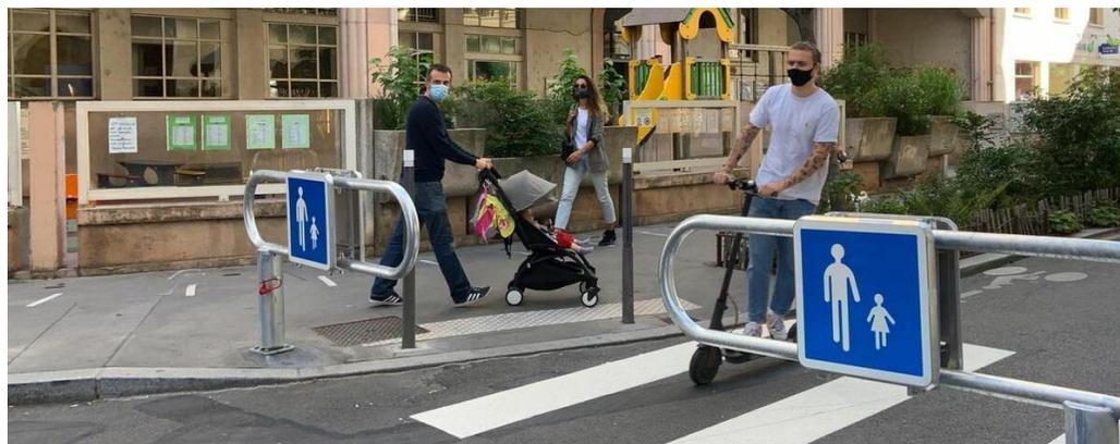
**Long terme** : Dispositif de blocage de long terme avec barrières pivotantes pour filtrer le passage des véhicules suivant les horaires (Crédits : Ville de Paris).
