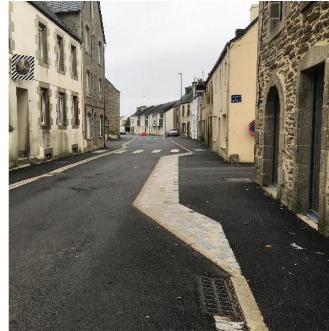
Réaménagement du bourg de Plouvorn : apaisement par la mise à niveau de la chaussée et des trottoirs et par des chicanes avec cédez le passage à la circulation venant en sens inverse ; changement de revêtements de sol ; végétalisation ; installation de mobilier urbain
