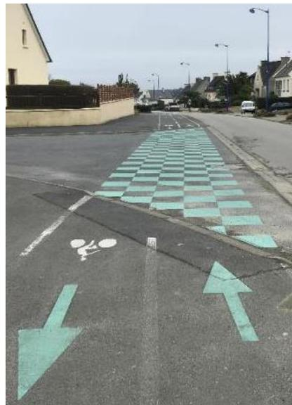
Piste cyclable sur trottoir, à Plouvorn, avec traversée matérialisée en damier. L'implantation d'un aménagement cyclable sur trottoir présente l'avantage de ne pas nécessiter de travaux lourds de voirie. Cependant, il induit de potentiels conflits d'usages avec les piétons et se traduit le plus souvent par une gestion des intersections peu satisfaisante
